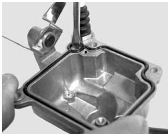
Supportare adeguatamente il carburatore e mediante spina e martello rimuovere il perno del galleggiante agendo dal lato comando gas.
