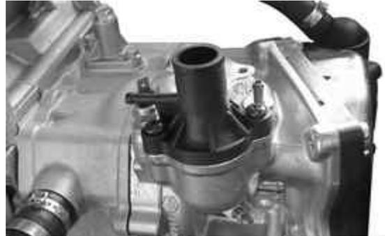
**Coppie di bloccaggio (N\*m)****Viti coperchio termostato 3 ÷ 4**
